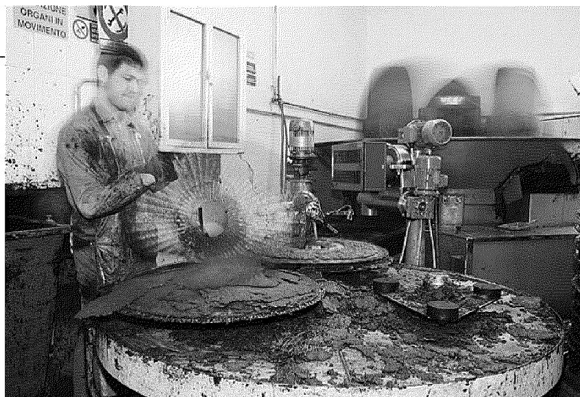
La spremitura meccanica delle olive al frantoio
