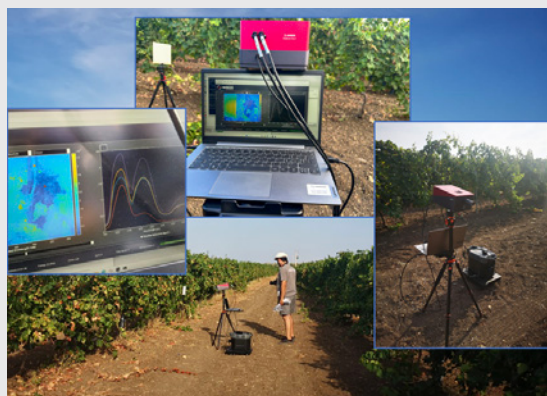
Figura 1. Sistema portatile di imaging iperspettrale SWIR
