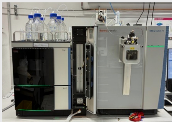
Figura 1. Spettrometro di massa ad alta risoluzione accoppiato a cromatografia liquida ad alte prestazioni (HPLC-HR-MS) utilizzato per l'analisi della qualità di olio d'oliva e vino
